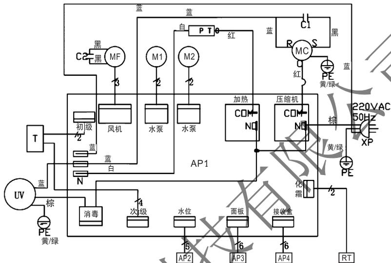
C2 : 风机电容    MF : 风扇电机    M1 : 水泵    M2 : 水泵
